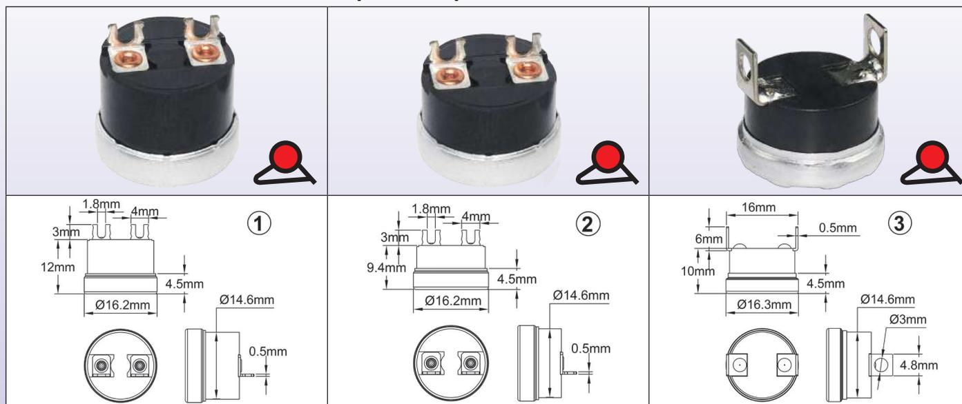
Questo termostato a disco è adattato al montaggio all'estremità del cavo, con terminali a saldare di piccole dimensioni e coppa in alluminio. Resiste al riempimento con silicone o epossidico. Il termostato si apre all'aumentare della temperatura.
