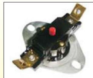
I termostati bimetallici a temperatura fissa sono dispositivi la cui temperatura è fissata in fabbrica e che non prevedono l'accesso al set-point da parte dell'utente. Sono utilizzati, a seconda del modello, come dispositivi di controllo o di sicurezza. I contatti possono essere di tipo lento, a scatto, di controllo o di ripristino, normalmente aperti, normalmente chiusi o SPDT. Sono possibili quasi tutte le opzioni di contatto sopra descritte.
