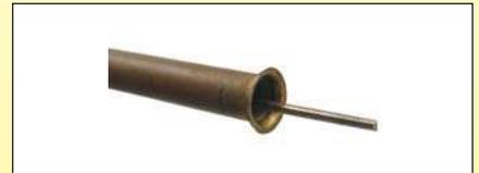
Utilizzando lo stesso metallo per il tubo esterno e l'asta interna si ottengono controlli che rispondono solo a rapide variazioni di temperatura e che vengono utilizzati nei rivelatori di incendio.
