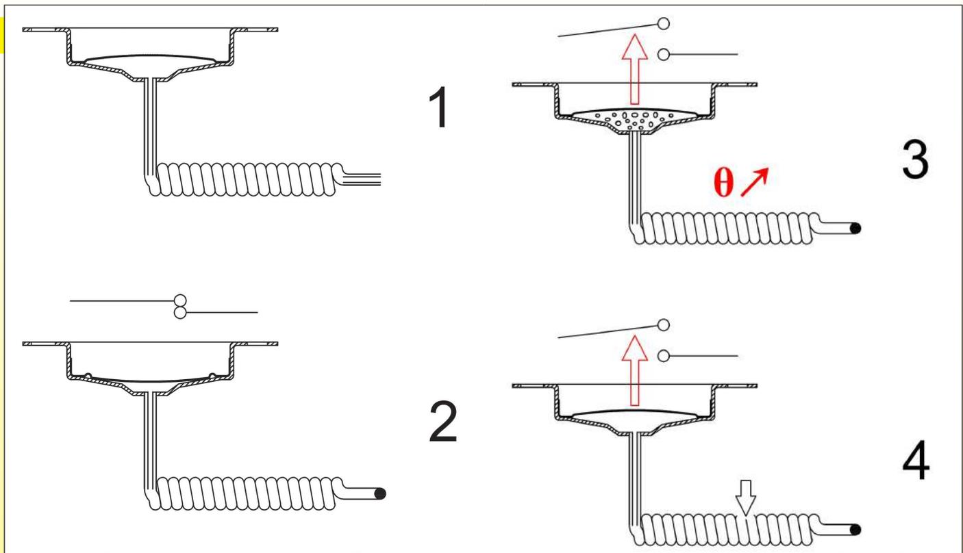
**Nei sistemi di sicurezza ad ebollizione, il soffietto del Diastat è costituito da due piatti, uno dei quali è a forma di botta.** Questa protuberanza è di forma convessa, come un disco bimetallico, e scatta da convessa a concava quando è sottoposta a una forza. Il Diastat, prima del riempimento (1), è costruito in modo che la coppa, in posizione non sollecitata, sia rigonfia verso l'esterno.
