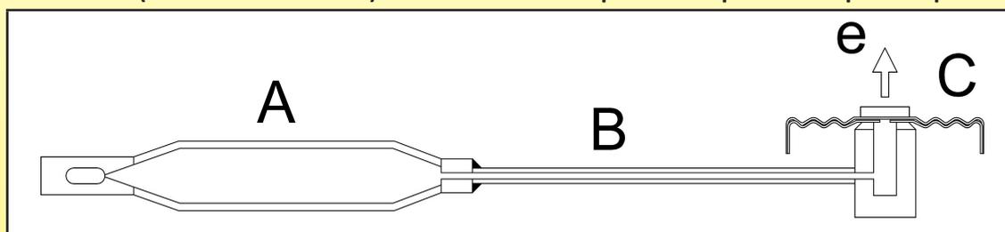
I termostati a lampada e a capillare hanno un sottogruppo chiuso chiamato «Diastat».
