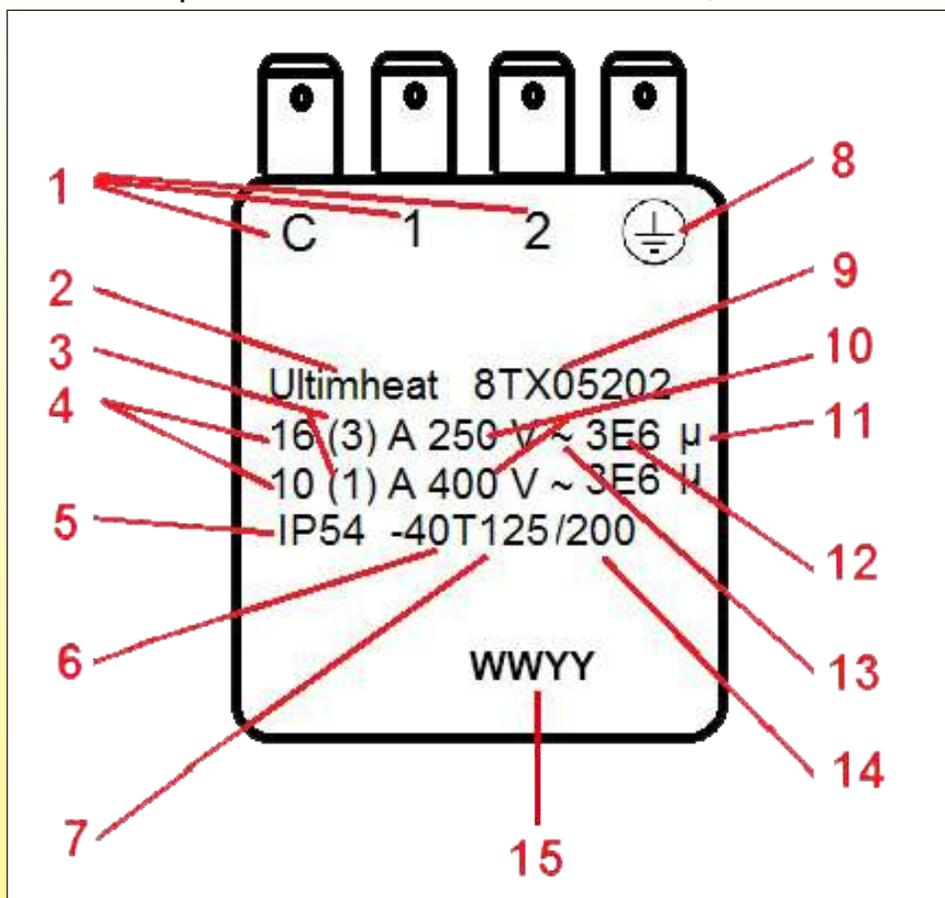
1: identificazione dei terminali adatti al collegamento di conduttori esterni, e se sono adatti per i conduttori di linea o di neutro, o per entrambi.
