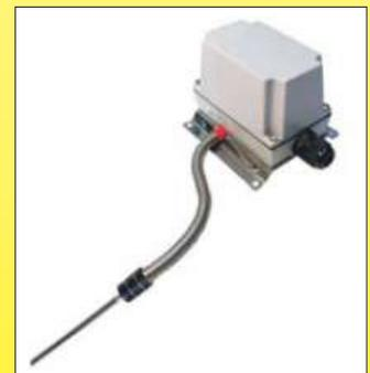
È lo strumento più comune per la misurazione e il controllo della temperatura a distanza. La lunghezza del capillare può raggiungere i 3 metri, ma con una deriva significativa dovuta alla quantità di liquido all'interno del capillare.
