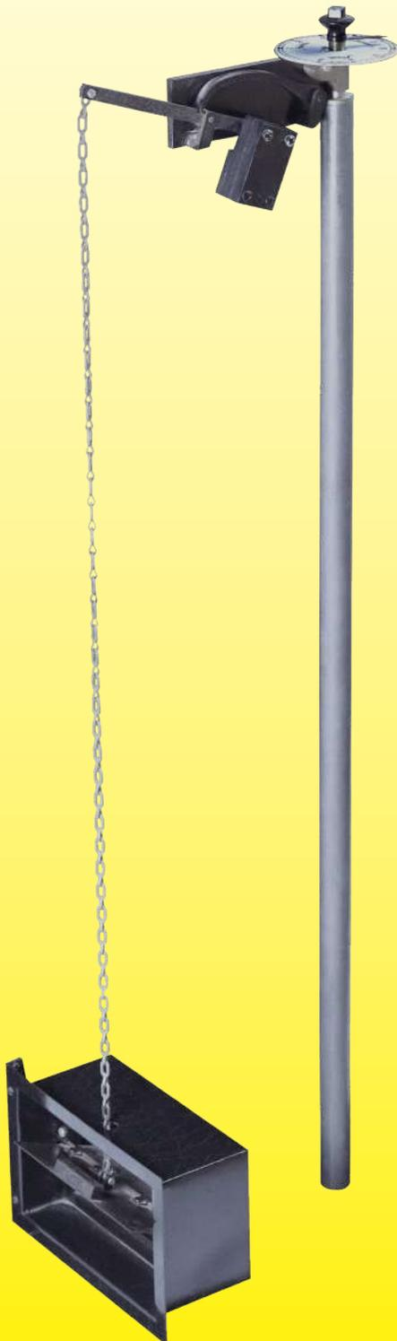
*1788. Il primo termostato ad asta denominato "Régulateur du feu" inventato e costruito da Jean Simon Bonnemain, ingegnere francese, per controllare la temperatura di un Incubatoio nei sobborghi di Parigi, riscaldato dalla prima caldaia a termosifone, anch'essa inventata per l'occasione.*
