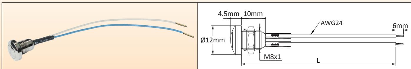
Interruttore cablato per il reset manuale. Necessita di un foro del diametro di 8 mm nella scheda di montaggio. Lunghezza dei fili 100 mm. Altre lunghezze su richiesta.
