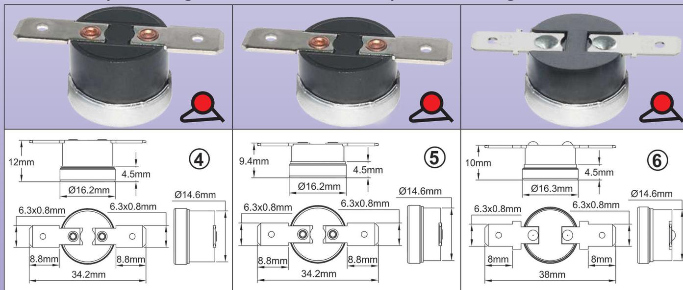
Termostato antigelo, per il montaggio sull'estremità del cavo di riscaldamento sotto una guaina termoretraibile a doppia parete, con terminali a linguetta orizzontale 6.3 × 0.8, per connettori rapidi o saldature. Coppetta di rilevamento della temperatura in alluminio. Il contatto si apre all'aumentare della temperatura.
