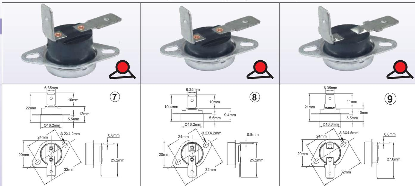
**Termostato antigelo, per montaggio passante a parete su scatole di derivazione o di connessione, terminali a linguetta 6,3 × 0,8.** Tazza estesa di alluminio per il rilevamento della temperatura. Il contatto si apre all'aumentare della temperatura.
